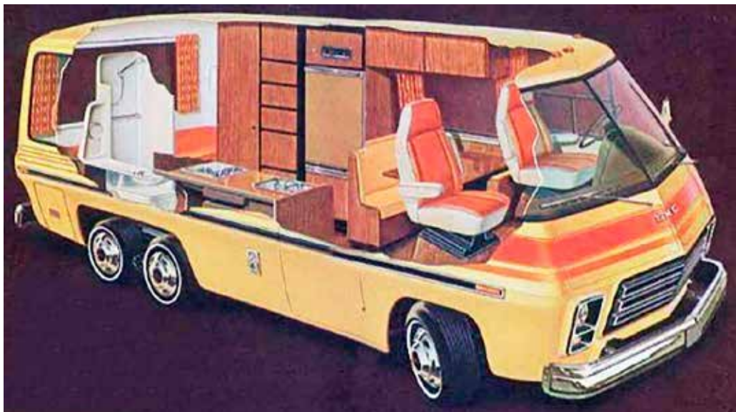
O motorhome da General Motors tinha estrutura própria e motor V8 com tração dianteira
