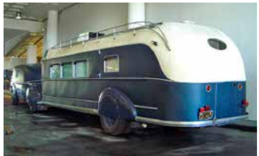
O Streamliner Aerocar utilizava o sistema de quinta roda para acoplar o veículo ao reboque
